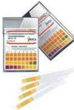
Per semplificare ulteriormente l'analisi dell'acqua, si possono utilizzare cartine al Tornasole tipo Acquaceck o equivalente.
